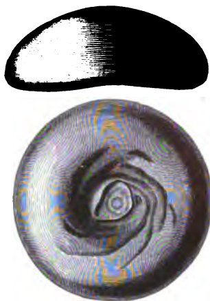
446. \frac{1}{2} Sømglatte af Glas, seet fra Siden og nedefra. Instrument pour rabattre les coutures, en verre, vu de côté et de dessous.
